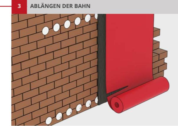
Benötigte Länge des **BTF MAUERFIX SANIERUNGSVLIES** abmessen und beispielsweise mit einer **Schere** auf die richtige Länge zuschneiden.
