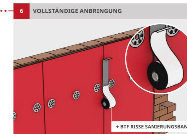
**Schritt 2 bis 4 wiederholen** und Bahnen Stoß an Stoß verlegen, um eine nahtlose Abdeckung der Wandfläche zu gewährleisten. Zusätzlich Fugen mit **Acrylat** verschließen.
