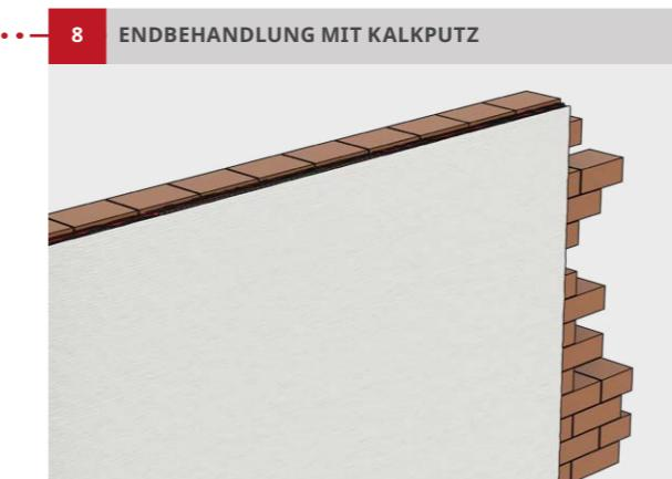
Trocknungszeit von 24 Stunden abwarten und **Kalkputz** auf die Wand auftragen. Die Wand ist damit fertig und bereit für den weiteren Innenausbau. Um die Schlag- bzw. Druckbelastung zu erhöhen und Spannungsrisse zu vermeiden, wird die Einarbeitung eines Armierungsgewebes für Innenputze empfohlen.
