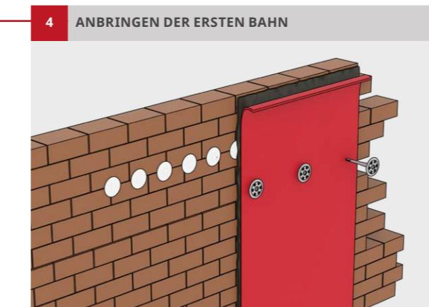
**Zugeschnittene Bahn** satt auf den aufgetragenen **Klebemörtel** aufbringen und fest an die Wand drücken. Für optimalen, langfristigen Halt das BTF MAUERFIX SANIERUNGSVLIES zusätzlich mit Tellerdübeln befestigen. Diese sind möglichst weit oben anzubringen. Die Bahn sollte gleichmäßig und spannungsfrei verarbeitet werden. Die roten Linien der Bahn sollten gerade verlaufen.
