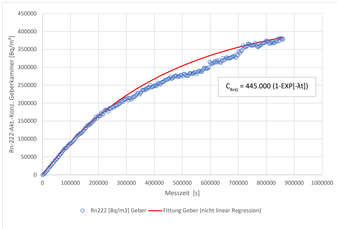
Abbildung 2: zeitlicher Verlauf der Radon-222-Akt.-Konz. in der Geberkammer – Prüfkörper 1
